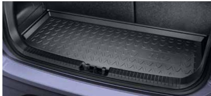
Bandeja protectora rígida para el suelo del maletero
